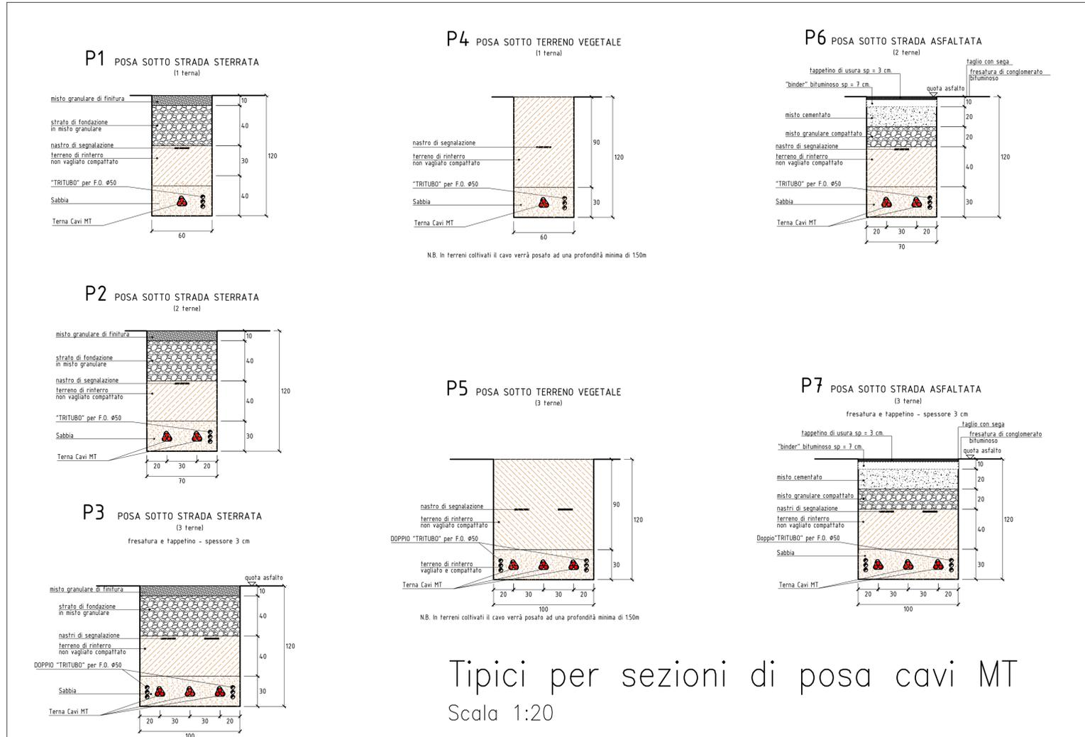
Tipico per sezione di posa sotto canale per cavi MT
